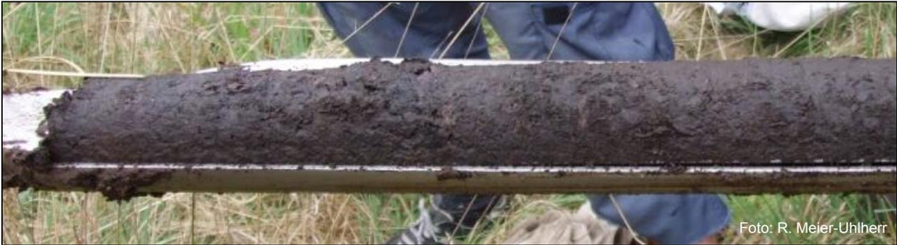
Amorpher/ hochersetzer Torf – typisch ist die einheitliche, sehr dunkle Masse ohne oder mit sehr wenigen erkennbaren Pflanzenresten
